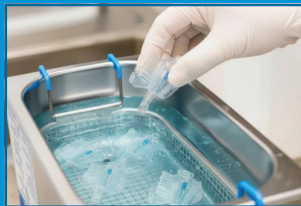
Ultraschallreinigung (3–10 Min. mit Enzymlösung)
