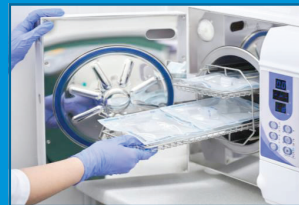
Autoklavieren bei 121 °C (15–20 Min.)
