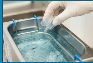
Ultraschallreinigung (3–10 Min. mit Enzymlösung)
