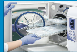
Autoklavieren: 121 °C für 15–20 Minuten ODER 135 °C für 3 Minuten
